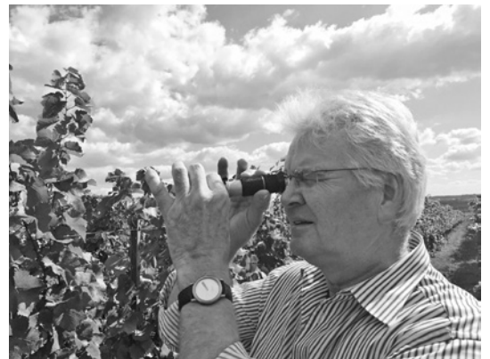
Norbert Barth misst den Oechslegehalt (Mostgewicht) der Trauben in der Lage Hattenheimer Hassel mit dem Refraktometer
